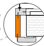
Šírka v rozsahu nad 20 mm sa nastavuje tak, že sa rozširía jednotlivé komponenty rámu dverí – tunel (priplatok).
